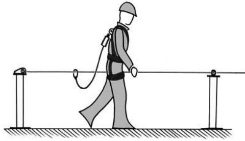
Figura 8. Línea de anclaje flexible horizontal
